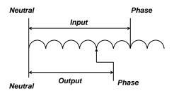
IT IS IMPERATIVE THAT ONLY THE NEUTRAL OF THE SUPPLY IS CONNECTED TO THE COMMON TERMINAL.
